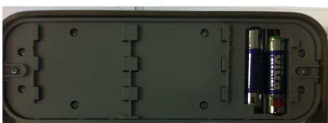
Coloque dos baterías tipo AAA como se indica en el compartimento. Vuelva a cerrar la tapa haciéndola deslizar.
