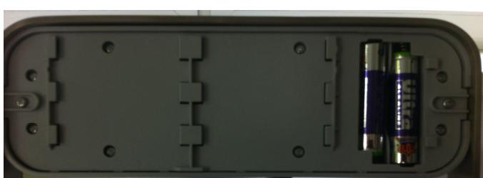
Insérez 2 piles AAA dans la position indiquée dans le compartiment à batterie. Lorsque vous avez terminé, remettez le panneau en place.
