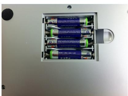
Plaats de 4 AAA batterijen zoals in het batterijvakje is aangegeven. Ten slotte plaatst u de batterijafdekking weer terug.
