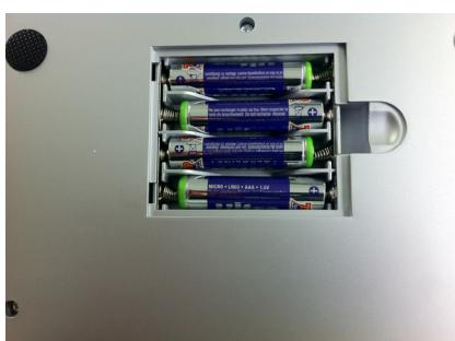
Insérez 4 piles AAA dans la position indiquée dans le compartiment à batterie. Lorsque vous avez terminé, remettez le panneau en place.
