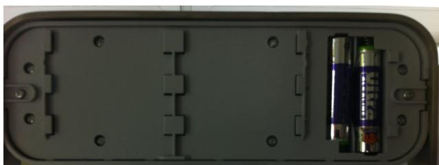
Legen Sie 2 AAA-Batterien ein, so wie es im Batteriefach angezeigt ist. Zum Schluss schieben Sie die Abdeckung wieder zurück.
