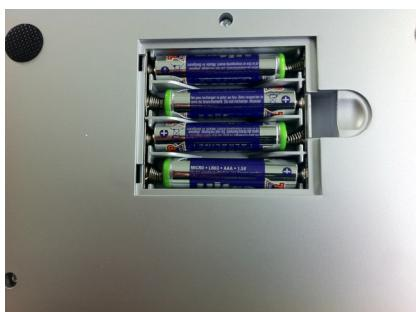
Coloque cuatro baterías de tipo AAA como se indica en el compartimento. Vuelva a colocar la tapa.
