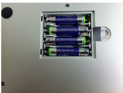
Legen Sie 4 AAA-Batterien so ein, wie im Batteriefach angezeigt. Zum Schluss legen Sie die Batterieabdeckung wieder auf.
