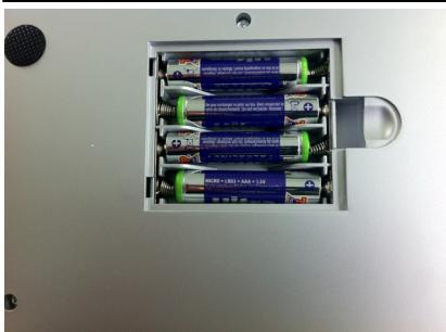
Introdurre 4 batterie AAA, così come indicato nel vano batterie. Alla fine rimettere la copertura delle batterie.
