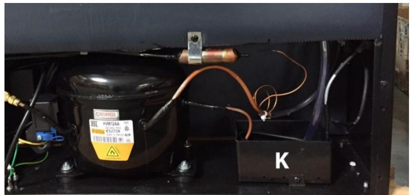
Si nécessaire, utilisez une éponge pour retirer l'eau de condensation du collecteur de condensation. Il se trouve à l'arrière de l'unité, en bas à droite. Veuillez retirer le couvercle métallique prévu à cet effet, puis le revisser.
