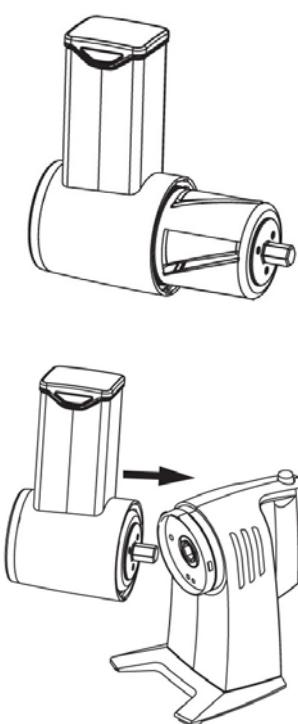
Wählen Sie die Edelstahlreibe aus, die gebraucht wird und stecken Sie diese in den Auswurf.
