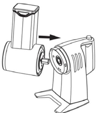
Coloque la salida de expulsión en la carcasa, asiendo firmemente la carcasa por el asa y colocando la salida de expulsión a un ángulo de 15°. El eje de accionamiento de la salida de expulsión debe quedar completamente enclavado en la carcasa. Gírela a izquierdas, hasta que la boca de llenado quede recta y esté centrada respecto al asa.
