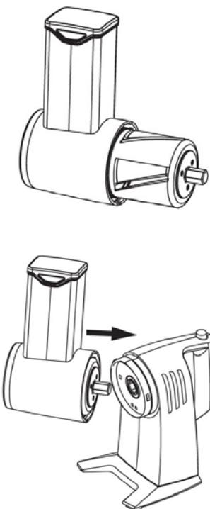
Selezioni la grattugia in acciaio INOX di cui necessita e la posizioni nel dispositivo d'uscita.
