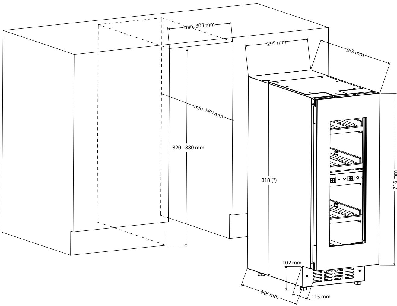
\* Die Einbauhöhe kann durch die verstellbaren Füße bis zu 878 mm erhöht werden.
