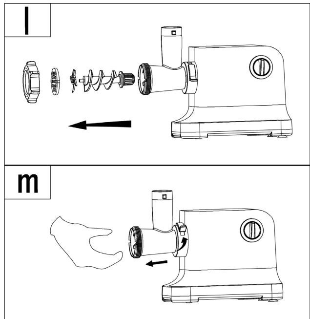
Spoel de onderdelen met heet water na en droog meteen af. U kunt stopper (5), mes (9), schijven (10, 11, 15), het opzetstuk voor de worstbereiding (13) en het opzetstuk voor deeg met sjabloon (14) in de vaatwasser wassen. Vet mes en schijf in met een beetje slaolie.
