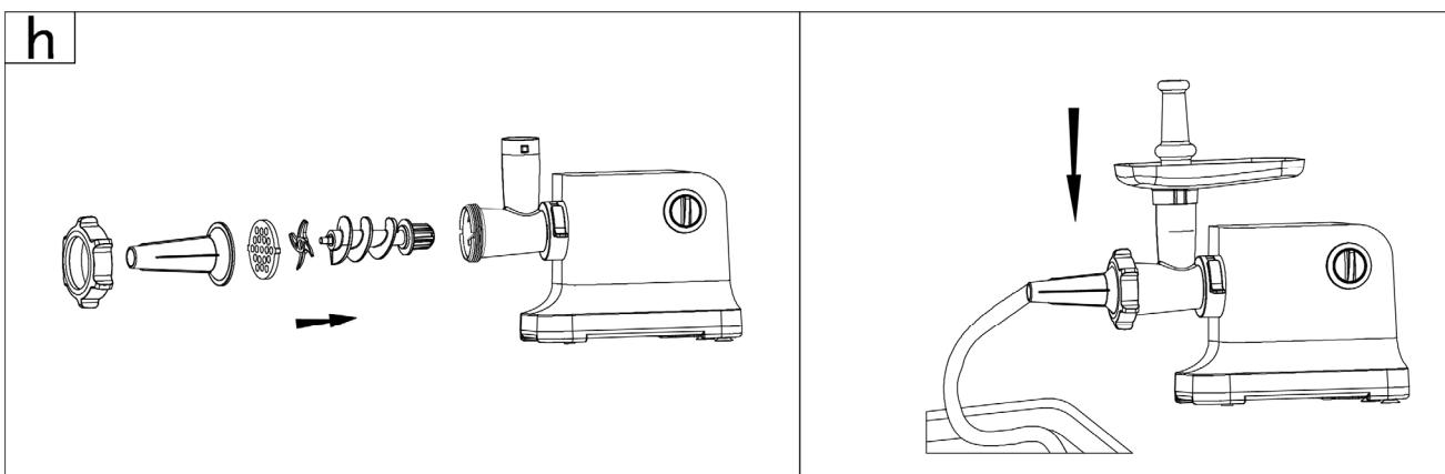
h) Para la producción de embutidos requerirá la boquilla para embutidos (13). Coloque el sinfín de compresión (8) como de costumbre con el extremo más grueso primero en el tubo colector (7). Coloque la cuchilla (9) y el disco perforado (10, 11 o 15) sobre el sinfín de compresión. A continuación, coloque la boquilla para la producción de embutidos (13) sobre la cuchilla (9) y disco perforado (10, 11 o 15). Apriete el anillo de fijación (12).
