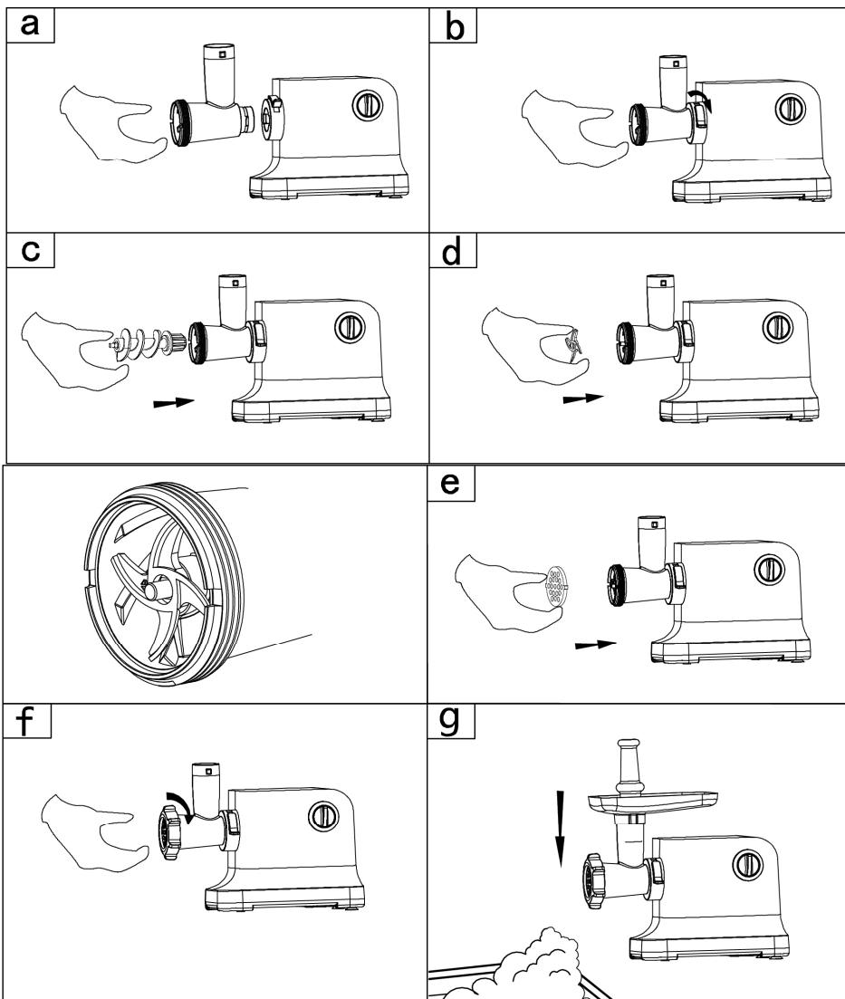
b) Schieben Sie den Arretierungs-Hebel (3) zum Befestigen nach unten.
