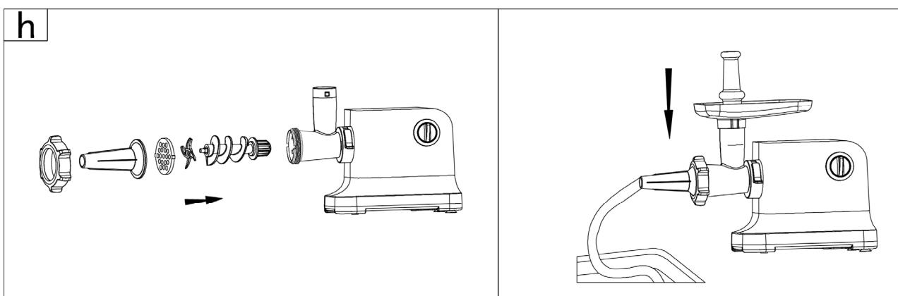
h) Sie benötigen den Aufsatz zur Wurstherstellung (13). Platzieren Sie die Schnecke (8) wie gewohnt mit dem dickeren Ende zuerst in das Schneckengehäuse (7). Setzen Sie Messer (9) und Lochscheibe (10, 11 oder 15) auf die Schnecke. Platzieren Sie dann den Aufsatz für die Wurstherstellung (13) auf Messer (9) und Lochscheibe (10, 11 oder 15). Drehen Sie den Fixierungsring (12) fest.
