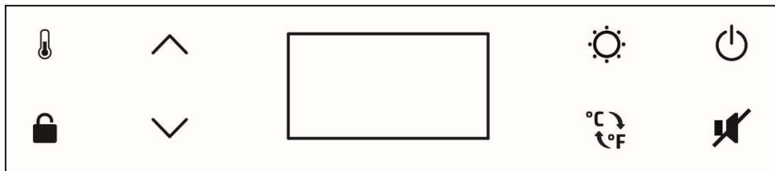
Durch Drücken der Taste Power schalten Sie das Gerät ein/aus.
