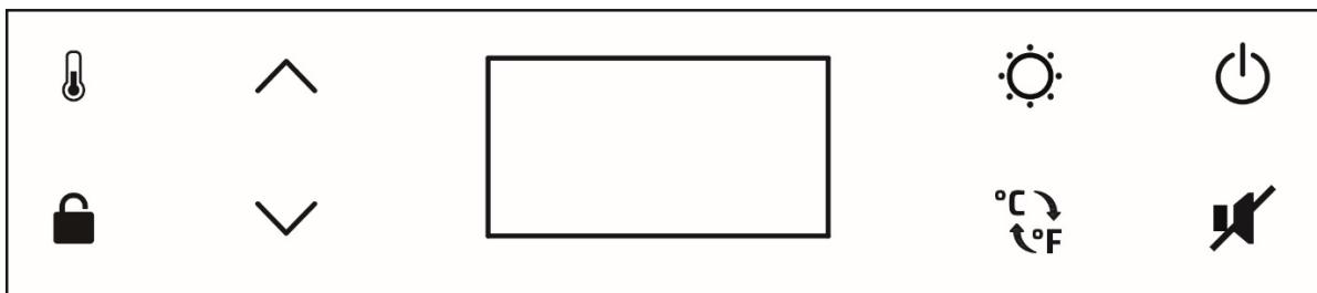
Al apretar el botón Power comutare el aparato on/off. Cuando el piloto LED está encendido, el aparato se encuentra en funcionamiento.
