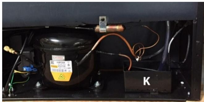
Deje el aparato descongelar cada 6 meses. Si abre con frecuencia la puerta del aparato, deberá realizar el proceso de descongelado con mayor frecuencia. Apague el aparato pero no desconecte el cable de alimentación. A continuación, deje que el aparato se descongele manualmente. Preste atención al recipiente de recogida del agua (K) y vaya retirando el agua que sale poco a poco durante el descongelado.
