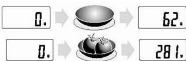
In modalità pesatura, posizionare un contenitore sulla superficie di pesatura, il display visualizzerà il peso del contenitore.
