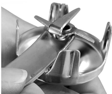
Virar o aparelho de modo a que as lâminas fiquem viradas para cima. Alavancar as lâminas para cima com a forquilha de aço inoxidável, como mostra a fotografia.
