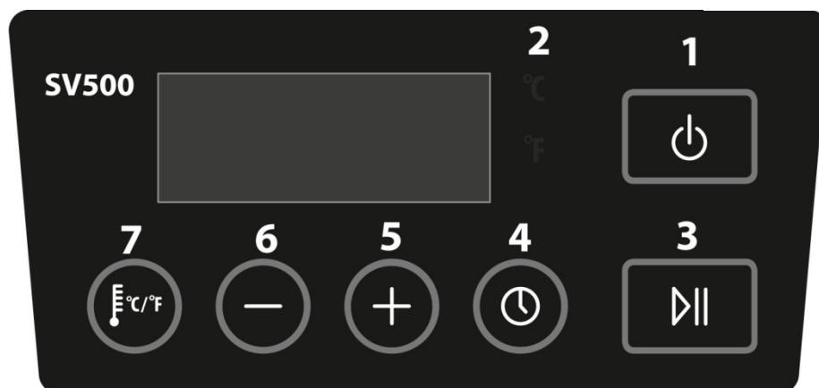
**1 Taste On/Off:** Zum Einschalten die Taste ON/OFF 1 Sekunde lang drücken. Die LED-Anzeige leuchtet auf.
