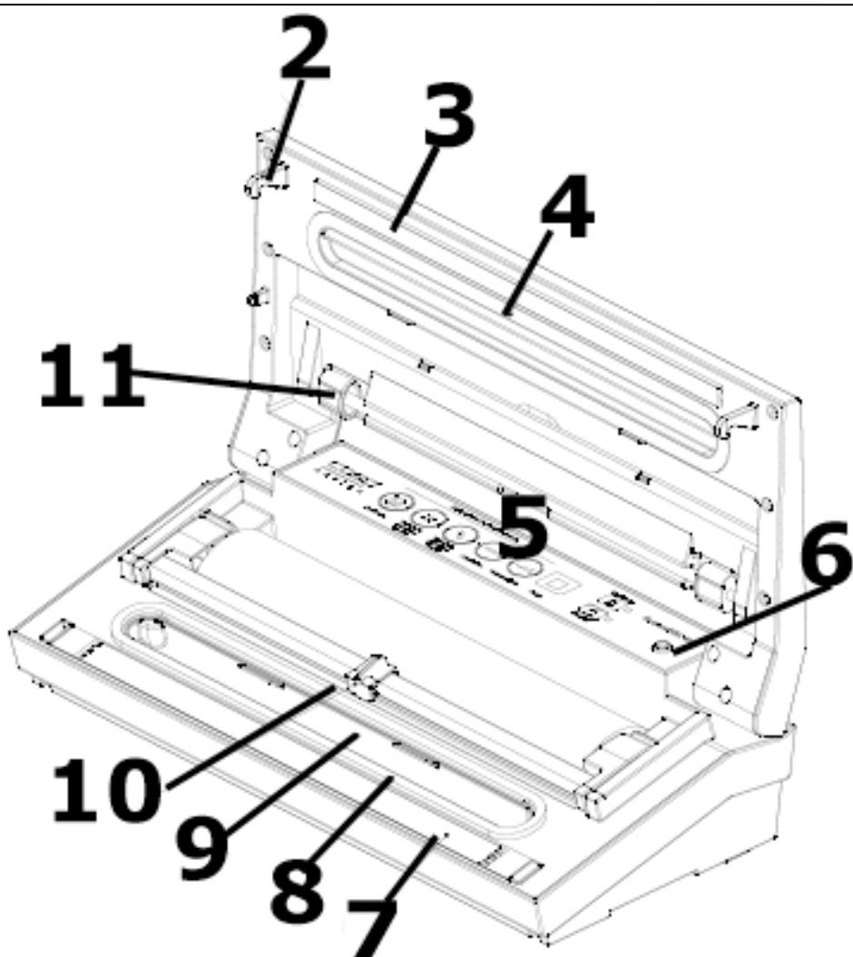
**2 Crochets de verrouillage pour le couvercle**
