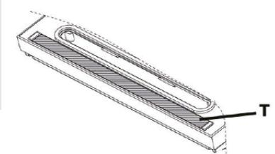
**9 herausnehmbare Vakuum-Kammer:** Verhindert, dass Luft aus dem Beutel austritt und entfernt überschüssige Flüssigkeit. Das offene Ende des Beutels muss innerhalb der Kammer positioniert werden. Die Kammer kann leicht herausgenommen und gewaschen werden.
