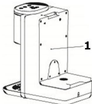
Se l'apparecchio dovesse erogare solo acqua, allora premere il tasto Reset. Utilizzare la chiave di reset in dotazione per il tasto Reset.
