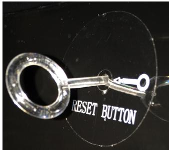
Durch Betätigung der Reset-Taste (1) kann das Gerät wieder reaktiviert werden. Ziehen Sie vor dem Reset-Vorgang den Netzstecker. Sollte das Gerät nur noch kaltes Wasser ausgeben, dann bitte die Reset-Taste drücken. Bitte nutzen Sie den beiliegenden Reset-Schlüssel für die Reset-Taste.
