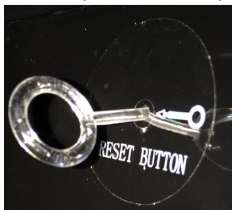
La unidad se puede reactivar pulsando el botón reset (1). Desconecte el enchufe de alimentación antes de resetear.
