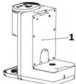
L'appareil peut être réactivé en appuyant sur le bouton reset (1). Débranchez l'appareil avant de le réinitialiser.
