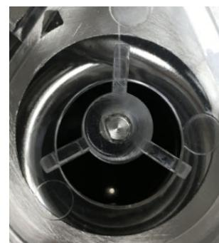
Pour le démontage, tournez le tablier en inox dans le sens inverse des aiguilles d'une montre. Veillez à ce que le propulseur n'accroche pas. Il doit être positionné au centre.
