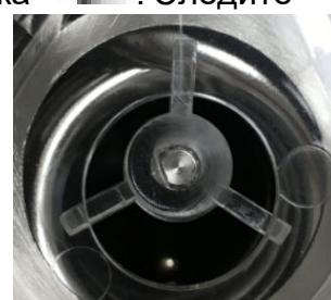
чтобы стрелка указывала на значок закрытого замка: . Для демонтажа поворачивайте кожух из нержавеющей стали против часовой стрелки. Следите за тем, чтобы рабочее колесо не зацепилось. Оно должно быть расположено по центру.
