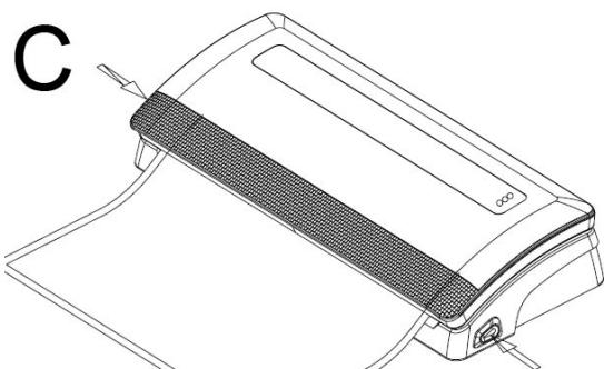
6. Contrôlez le sac mis sous vide ; il devrait présenter une soudure à l'emplacement du scellage et n'avoir pas de plis. Si ce n'est pas le cas, l'emballage n'est pas hermétique.
