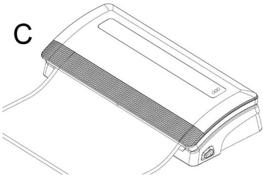
5. Quando la saldatura è terminata (LED 11), premere i tasti di sblocco (2), aprire il coperchio e rimuovere il sacchetto.
