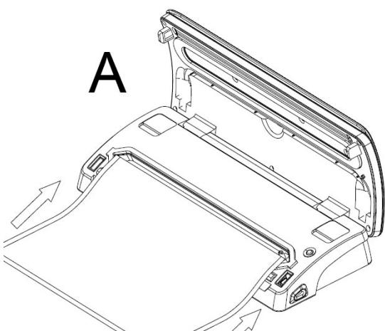
2. Limpie y alise el extremo abierto de la bolsa y asegúrese de que no presente pliegues ni abombado en la superficie del extremo abierto.
