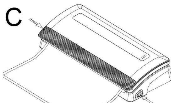
5. Wenn der Schweißvorgang beendet ist (LED 11), drücken Sie die Entriegelungs-Tasten (2) (Abbildung C), öffnen den Deckel und entnehmen Sie den Beutel.
