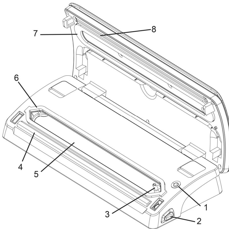
**6 Joint inférieur:** assure l'étanchéité de la partie inférieure de la chambre à vide.
