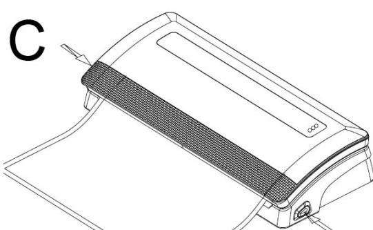
5. Si el proceso de sellado ha finalizado (LED 11), pulse las teclas de desbloqueo (2) (Ilustración C), abra la tapa y retire la bolsa.
