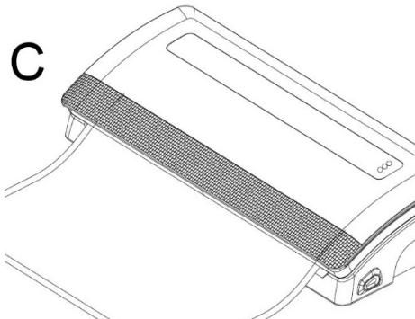
4. Fermez le couvercle et appuyez avec les mains sur ses extrémités jusqu'à ce que vous entendiez le moteur de l'appareil se mettre en marche. Appuyez sur le couvercle pendant quelques secondes (image C). L'appareil resserre le couvercle et scelle le sac. L'appareil s'arrête automatiquement quand le sac est scellé.
