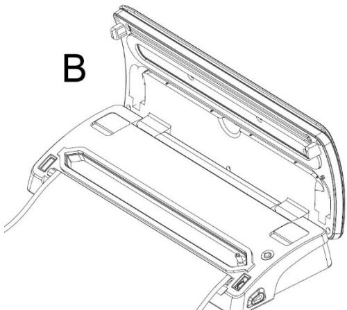
3. Nettoyez et défroissez le côté ouvert du sac et assurez-vous qu'il n'y ait ni pli ni repli sur la surface du côté ouvert. Placez un côté du sac sur le joint en caoutchouc (4) et le joint inférieur (6). Le côté ouvert du sac ne doit pas être placé dans la chambre à vide (5) (image B).
