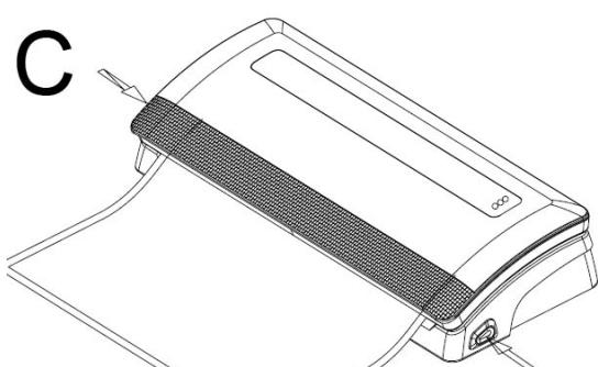
5. Wanneer het lasproces is afgesloten (LED 11), drukt u op de ontgrendelingsknop (2) (afbeelding C), opent u het deksel en neemt u het zakje uit het apparaat.
