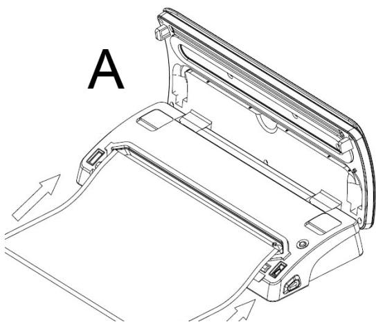
3. Mettere il sacchetto nella camera del vuoto (5) come si vede alla figura (A). Non mettere il sacchetto sopra il bocchettone di aspirazione (3), altrimenti il vuoto non può essere correttamente generato.
