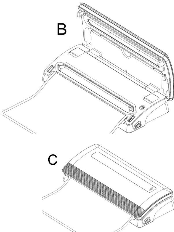
2. Legen Sie ein Ende des Beutels über die Gummidichtung (4) und die untere Dichtung (6). Das offene Ende darf nicht in die Vakuumkammer (5) gelegt werden (Abbildung B).
