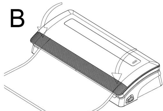
4. Chiudere il coperchio e premerlo su entrambi i lati, prima a sinistra e poi a destra, con le mani verso il basso (Figura B) finché ingranà e sentite che l'apparecchio mette sotto vuoto il sacchetto (LED 9) e poi lo salda (LED 10). L'apparecchio si arresta automaticamente.
