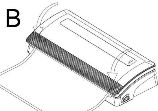
4. Schließen Sie den Deckel und drücken Sie ihn erst links mit der Hand fest nach unten dann rechts (Abbildung B), der Deckel rastet ein. Sie hören, dass das Gerät den Beutel vakuumiert (LED 9) und dann verschweißt (LED 10). Das Gerät stoppt automatisch.
