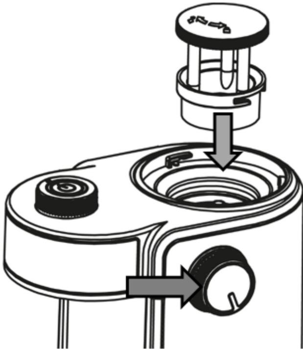
Mahlwerk aufsetzen und dann leicht hin und her drehen, so dass das Mahlwerk in die Führung nach unten rutscht.
