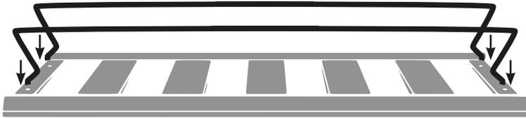
Stecken Sie die Edelstahlvorrichtung in die vorgebohrten Löcher auf der Unterseite des Holzlagerbodens. Drehen Sie das zusammengebaute Regal um und stellen Sie es in den Weinkühlschrank.
