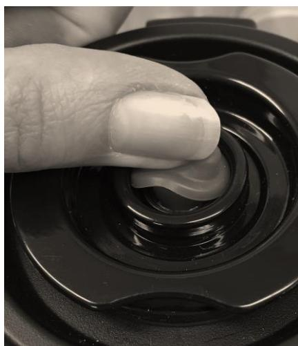
Si vous voulez mettre fin à la dépression, enfoncez la soupape de mise sous vide vers le côté.
