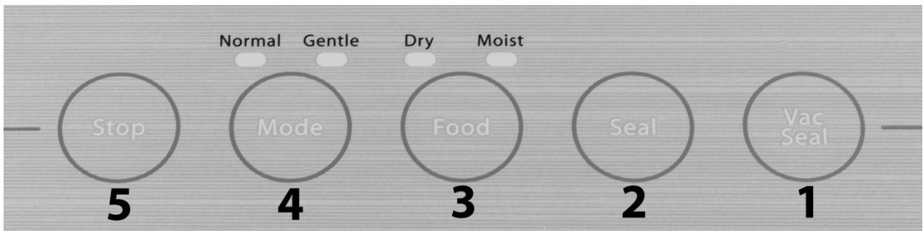
**1 Vide/Scellage (Vac Seal):** Permet de faire sortir l'air du sac et de sceller automatiquement le sac après la mise sous vide.
