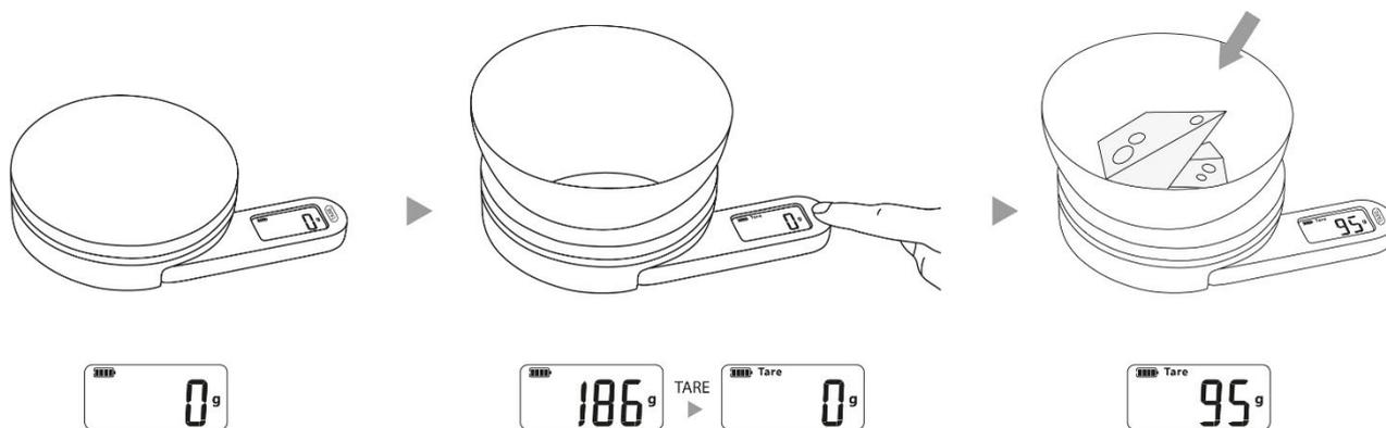
Colocar un recipiente en la bandeja de pesaje, la pantalla muestra el peso del contenedor. Pulse TARE, la pantalla a cero.
