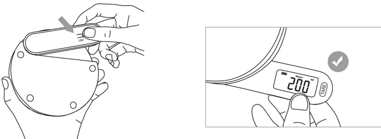
Drücken Sie die UNIT Taste (auf der Rückseite des Displays) um die Gewichtseinheiten zwischen g, oz, Water ml, Milk ml umzustellen.
