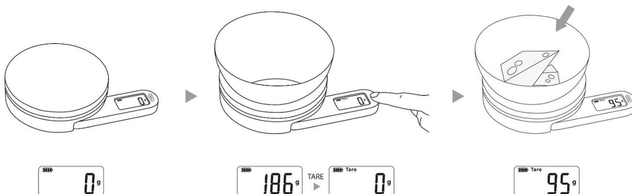
Stellen Sie einen Behälter auf die Wiegefläche, das Display zeigt das Gewicht des Behälters an. Drücken Sie die Taste TARE, das Display zeigt null an. So ist das Gewicht des Behälters gelöscht und Sie können den Inhalt des Behälters wiegen. Wenn Sie den Behälter entnehmen, zeigt die Waage das negative Gewicht, drücken Sie TARE und das Display zeigt nach 2 Sekunden Null an.
