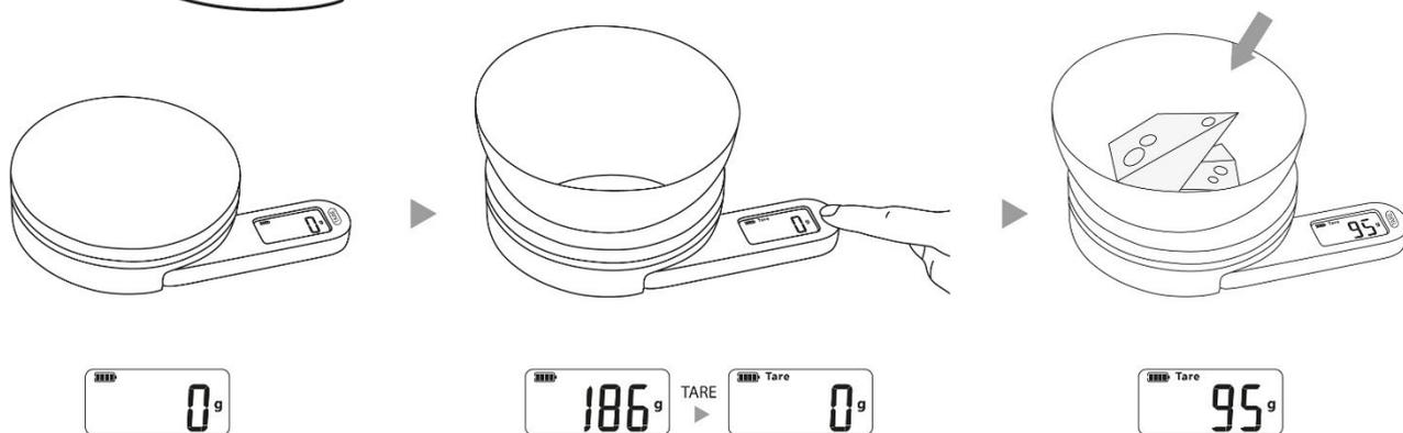
Поместите на весы пустую тару. На дисплее отобразится ее вес. Нажмите кнопку TARA (TARE) и на дисплее отобразится ноль, а вес тары пропадет.
