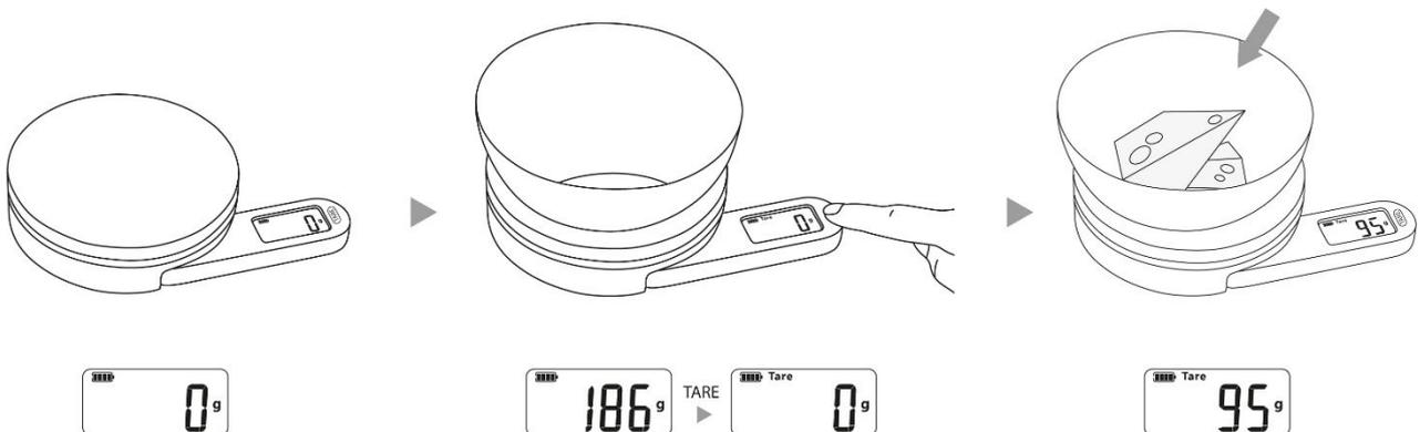
Plaats een container op het weegvlak, het display toont het gewicht van de container. Druk op de toets TARE, op het display op nul. Dus het gewicht van de container verwijderd en u kunt weegt de inhoud van de container.
