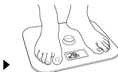
Presione con el pie o la mano el botón hasta que el condensador quede totalmente cargado mediante tecnología dinamo.
