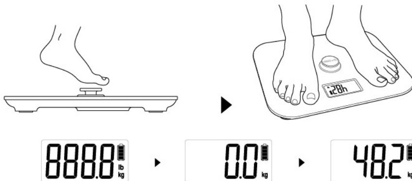
Drücken Sie mit Fuß oder Hand auf die Taste bis der Kondensator mittels Dynamo-Technologie voll
