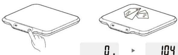
Drücken Sie die Taste „TARE“, das LED Display zeigt 0 an. Legen Sie das Wiegegut auf die Wiegefläche und das entsprechende Gewicht wird angezeigt.
