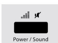
Druk 3 seconden op de knop **Vermogen/Sound** om de Sound (pieptoon) in of uit te schakelen. Beëindigingsberichten van de programma's en waarschuwingsignalen klinken ook bij uitgeschakelde sound.
