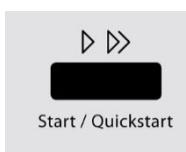
Gebruik deze functie om de oven voor het comfortabele koken bij 100% magnetron gebruik te programmeren. Druk snel achter elkaar op de **Start/Snelstart** knop om de kooktijd in te stellen. Druk éénmaal op **Start/Snelstart** om de kooktijd van 10 seconden in te stellen, tweemaal voor 20 seconden.
