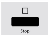
Drukt u de knop **Stop** drie seconden lang in, totdat u een pieptoon hoort en de functie zichtbaar is in het display "Lock". In vergrendelde toestand zijn alle knoppen gedeactiveerd.
