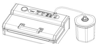
Fissare un'estremità del tubo flessibile per la messa sotto vuoto all'attacco sull'apparecchio e un'estremità all'attacco sul coperchio del contenitore.
