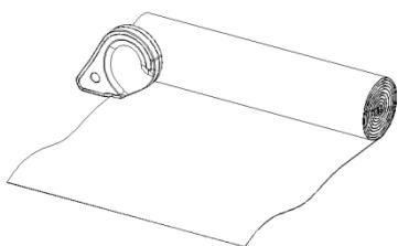
Rollen Sie die Folie auf die gewünschte Länge aus und schneiden Sie mit dem Cutter einen Beutel von der Rolle ab.
