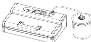
Befestigen Sie ein Ende des Vakuumierschlauches am Anschluss am Gerät und ein Ende am Anschluss auf dem Behälterdeckel.
