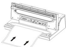
Vérifiez que le bout ouvert du sachet se trouve dans la chambre de dépressurisation pour garantir que l'air ne s'échappe pas. Ne bouchez pas l'entrée d'air.
