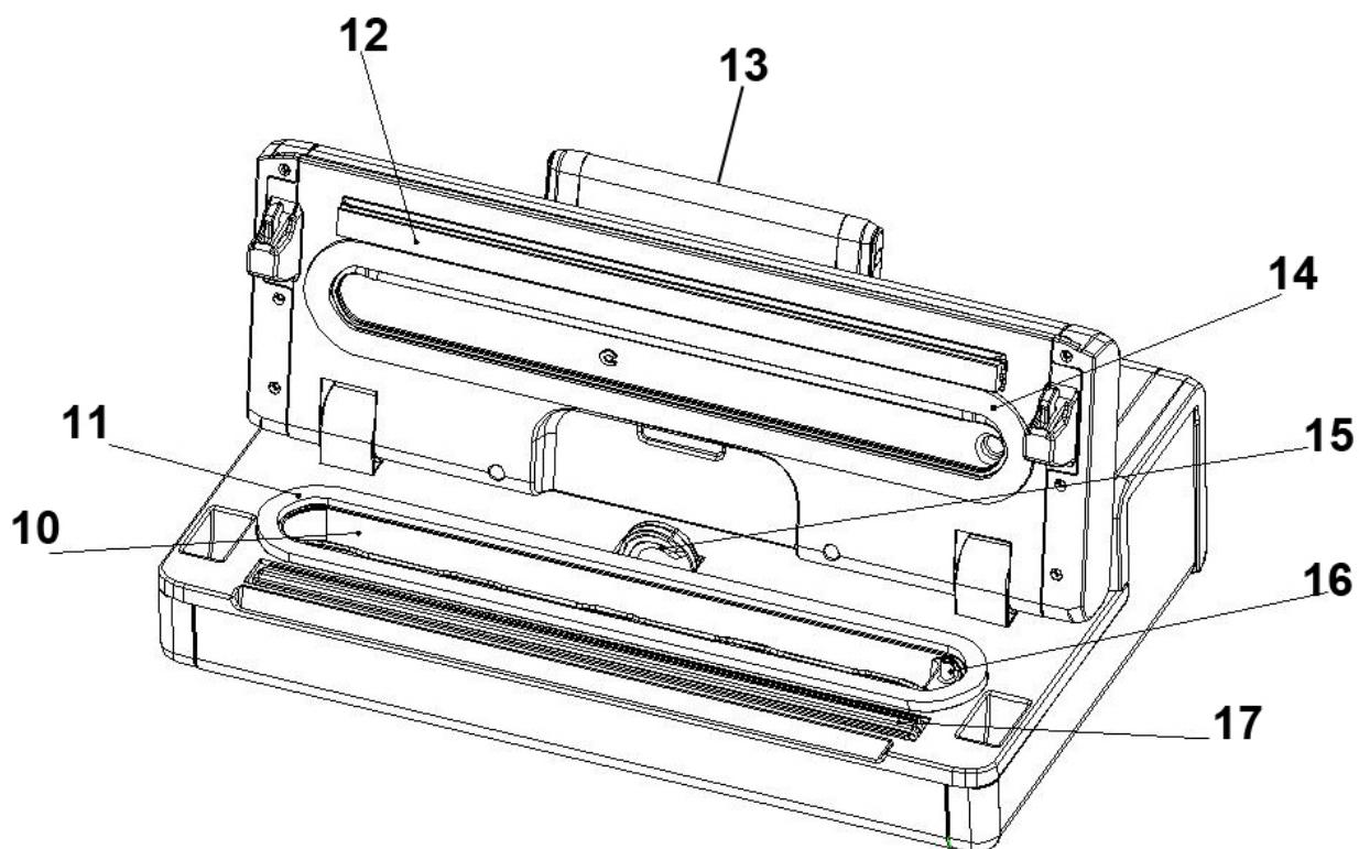
**10 Cámara de vacío:** Coloque la abertura de una bolsa en la cámara.
