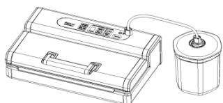
Controleer de LED-toestandsindicator voor de vacuümsterkte; die moet op „normaal“ (normal) staan. Sluit het deksel en druk deze stevig naar beneden op het voorste handvat.
