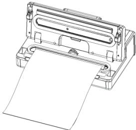
Verzeker u ervan dat het open eind van het zakje zich binnen de vacuümkamer bevindt. Het zakje mag niet over de aanzuigaansluiting worden gelegd.
