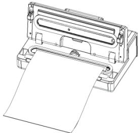
Vergewissern Sie sich, dass sich das offene Ende des Beutels innerhalb der Vakuumkammer befindet. Dies garantiert, dass kein Vakuum entweicht. Verdecken Sie nicht den Lufteinlass. Schließen Sie den Deckel und drücken Sie den Griff fest herab. Überprüfen Sie die LED-Zustands-Anzeigen und wählen Sie die von Ihnen gewünschte Versiegelungszeit und Vakuumstärke aus.
