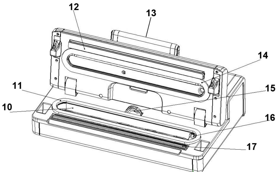
**10 Vakuumkammer:** Positionieren Sie die Öffnung des Beutels in der Kammer.
