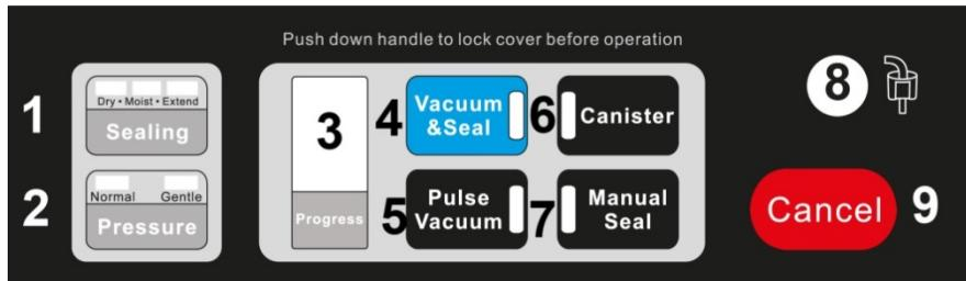
**1 Tiempo de sellado (Sealing):** Hay tres ajustes para seleccionar el tiempo de sellado "seco" (dry), para un producto al vacío seco o sin líquido, con intervalo de sellado corto. "húmedo" (moist), para un producto al vacío húmedo o con líquido, con intervalo de sellado normal.
