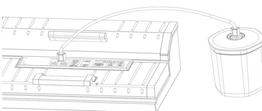
Fissare un'estremità del tubo flessibile per la messa sotto vuoto all'attacco sull'apparecchio e un'estremità all'attacco sul coperchio del contenitore.
