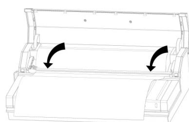
Öffnen Sie die obere Abdeckung. Überprüfen Sie, dass der Cutter an einem Ende der Cutterschiene positioniert ist. Drücken Sie dann die Cutterschiene wieder nach hinten.
