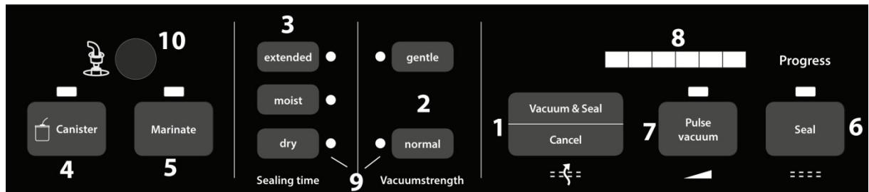
**1 Vacuüm & lassen / afbreken (Vacuum & Seal / Cancel):** Deze knop heeft twee functies, afhankelijk van de status van het apparaat
