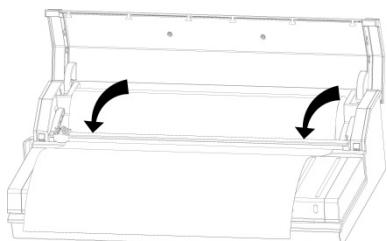
Mettez une extrémité du sachet sur le joint en caoutchouc, mais pas dans la chambre à vide.
