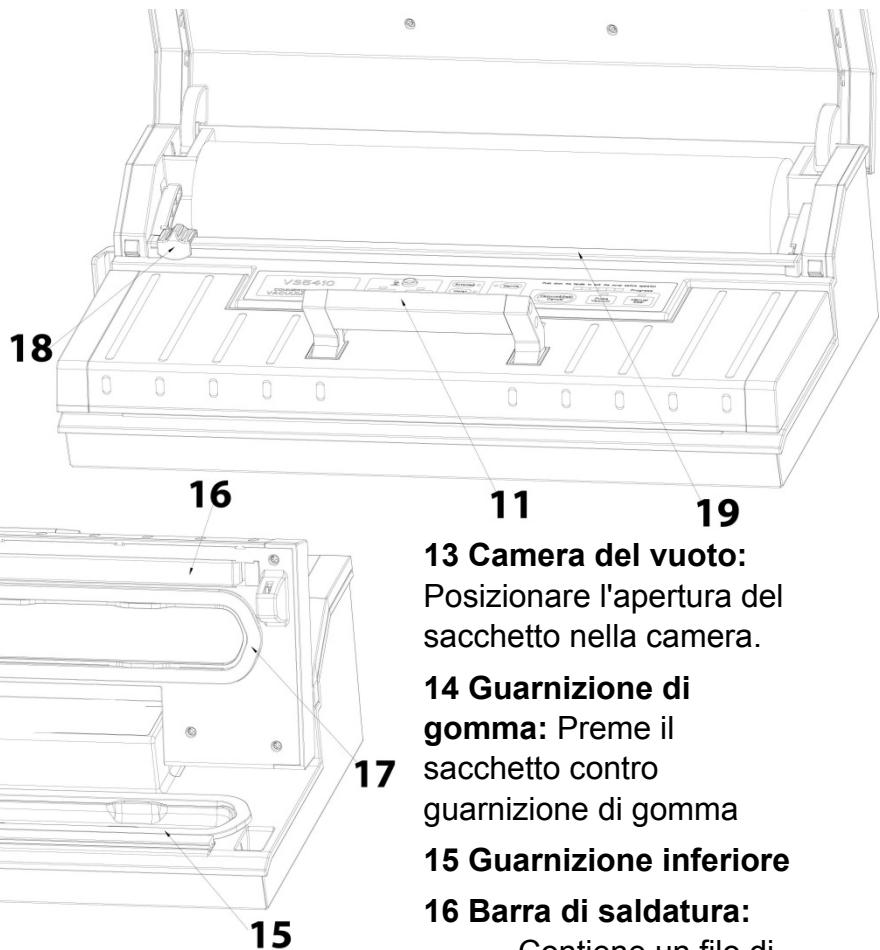
riscaldamento rivestito di teflon; questo consente di sigillare il sacchetto senza farlo incollare. Appoggiare il sacchetto sopra il filo di riscaldamento per poterlo sigillare.
