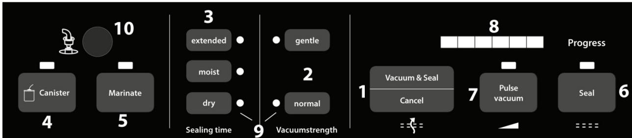
**1 Vacuum & Seal: Vakuum & Schweißen/Abbrechen:** Dieser Knopf hat zwei Funktionen abhängig vom Status des Gerätes
