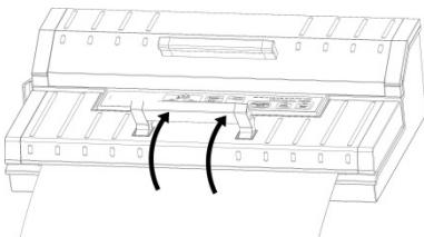
Drücken Sie den vorderen Griff wieder nach oben, öffnen Sie den Deckel und entnehmen Sie den Beutel. Dieser kann nun zum Vakuumieren benutzt werden.
