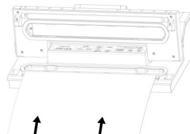
Vergewissern Sie sich, dass sich das offene Ende des Beutels innerhalb der Vakuumkammer befindet. Dies garantiert, dass kein Vakuum entweicht.
