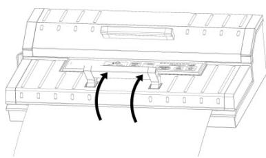
Druk op de kop „lassen“ (Seal). Het controlelampje gaat uit zodra het sealingproces is beëindigd.
