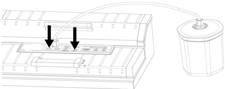
Compruebe la indicación de estado LED para observar la intensidad del vacío; debe estar seleccionado el ajuste "normal".
