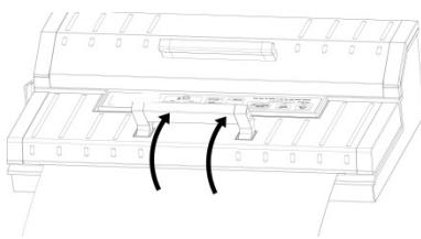
Pulse "Vacío y sellado".(Vacuum & Seal) La indicación de progreso LED se iluminará y se aspirará aire automáticamente hasta sellar la bolsa.
