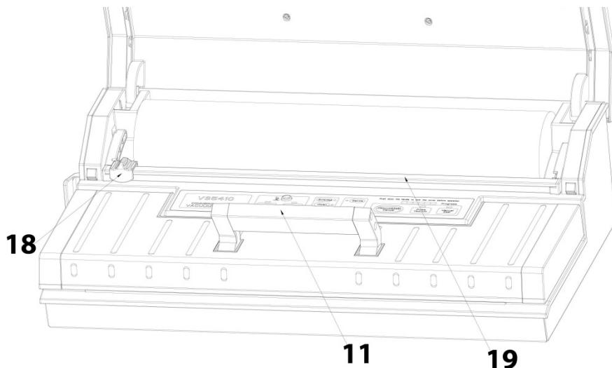
**11 Asa delantera:** Presionar hacia abajo para cerrar la tapa. Levantar para abrir la tapa.
