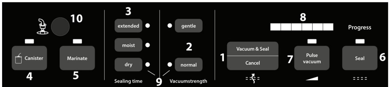
**1 Vacío y sellado/Interrumpir (Vacuum & Seal / Cancel):** Este botón tiene dos funciones, dependiendo del estado del aparato.
