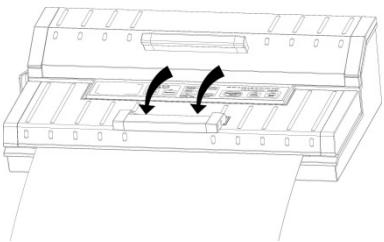
Cierre la tapa y presione firmemente hacia abajo el mango delantero.
