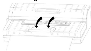
Premere "Sotto vuoto e saldatura" (Vacuum & Seal). L'indicatore di avanzamento a LED si accende e automaticamente viene aspirata aria e il sacchetto poi
