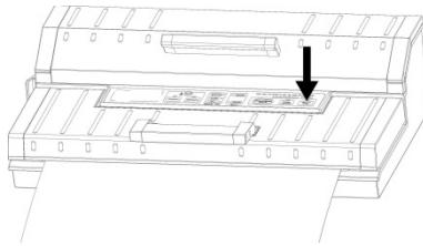
Suba el asa delantera nuevamente hacia arriba, abra la tapa y retire la bolsa. Ésta puede utilizarse ya para envasar al vacío.
