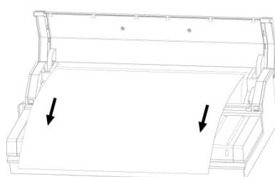
Rollen Sie die Folie auf die von Ihnen gewünschte Länge aus und schneiden Sie sie, mit einem genauen und sauberen Schnitt, auf die gewünschte Länge zu.
