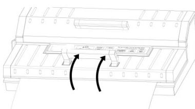
Drücken Sie "Vakuum & Schweißen" (Vacuum & Seal). Die LED-Fortschritts-Anzeige leuchtet auf und es wird automatisch Luft abgesaugt und der Beutel dann versiegelt.
