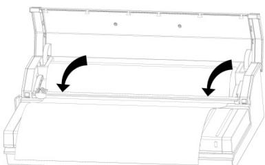
Enrolle la lámina hasta la longitud que desee y córtela hasta la longitud deseada mediante un corte preciso y limpio.
