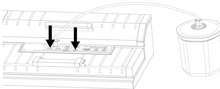
Sluit het deksel en druk deze stevig naar beneden op het voorste handvat. Druk op „Vacuümbak“ (Canister). Druk bij het begin van het vacumeren het deksel stevig aan, om te voorkomen dat er lucht kan ontsnappen. Het vacumeerproces eindigt automatisch wanneer een voldoende sterk vacuüm is bereikt. Verwijder de vacuümslang van de aansluiting aan het deksel van de bak en aan het apparaat.
