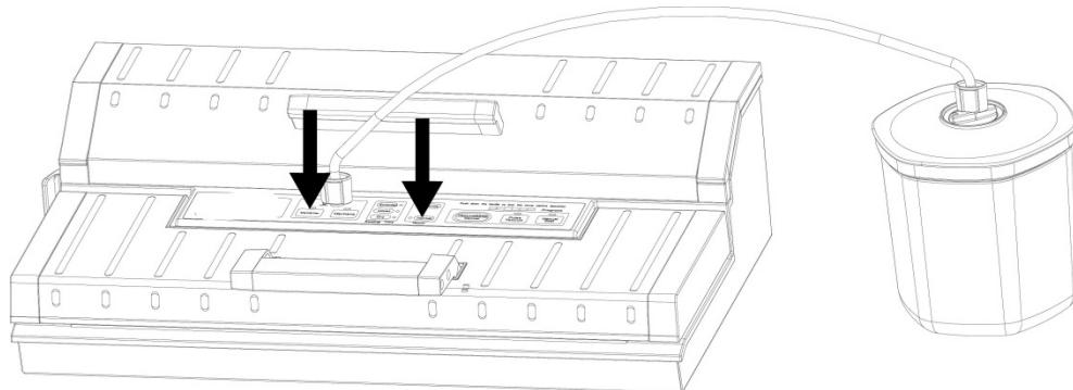
Befestigen Sie ein Ende des Vakuumierschlauches am Anschluss am Gerät und ein Ende am Anschluss auf dem Behälterdeckel.
