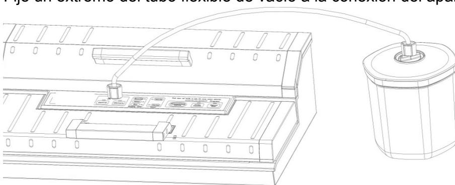
Compruebe la indicación de estado LED para observar la intensidad del vacío; debe estar seleccionado el ajuste "suave" (gentle) o "normal" (normal).
