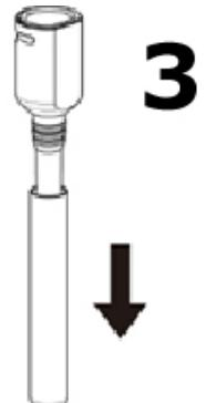
3. Schutzkappe nach unten schieben, um die Schutzkappe zu entfernen.
