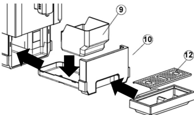
Poser le bac à marc sur le bac d'égouttage interne et glisser celui-ci dans l'appareil. Insérer ensuite le bac d'égouttage avec la grille d'égouttage.
