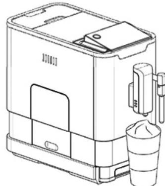
A continuación, coloque el recipiente con la espuma de leche bajo la salida de café. Pulse
