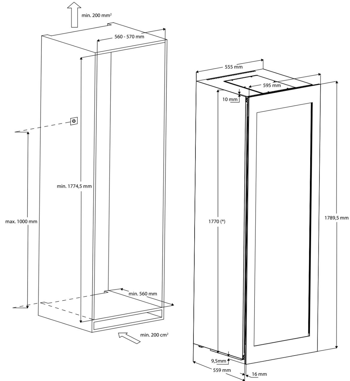
\* Die Einbauhöhe kann durch die verstellbaren Füße bis zu 1785 mm erhöht werden.
