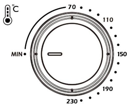
Voor de instelling van de baktemperatuur, niet om het apparaat uit te schakelen.
