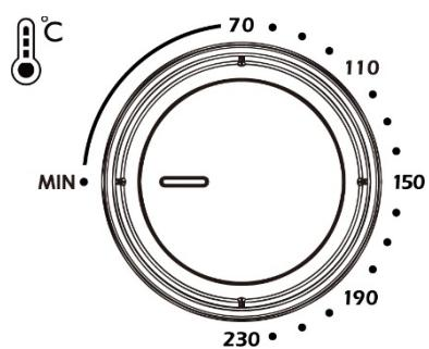
För inställning av tillagningstemperatur, inte för att slå från apparaten.
