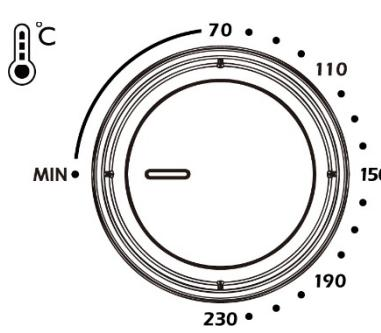
Предназначена для установки температуры термообработки, не для выключения устройства.
