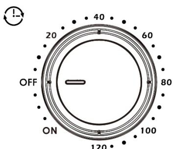
Ajuste siguiendo la dirección de las manillas del reloj (a derechas) el tiempo deseado y se encenderá el piloto luminoso.
