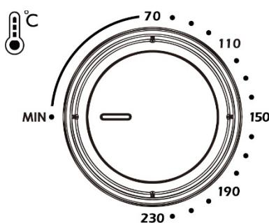
Para ajustar la temperatura de cocción, no sirve para apagar el aparato.
