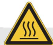
På den bakre övre kapslingssidan finns en varning för fara för heta ytor. Apparaten kan bli mycket het på ytan.
