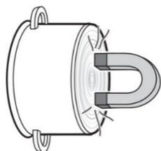
◆ Avvicini una calamita (per esempio una calamita fermacarte di una lavagna magnetica) al fondo del suo recipiente per la cottura. Se viene attratto con forza, potrà utilizzare il recipiente di cottura sulla superficie di cottura ad induzione.
