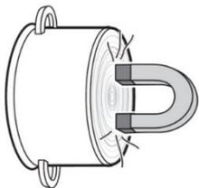
◆ **Führen Sie einen Magneten (z.B. einen Haftmagneten einer Magnettafel) an den Boden Ihres Kochgefäßes heran. Wird er kräftig angezogen, so können Sie das Kochgefäß auf der Induktionskochfläche benutzen.**
