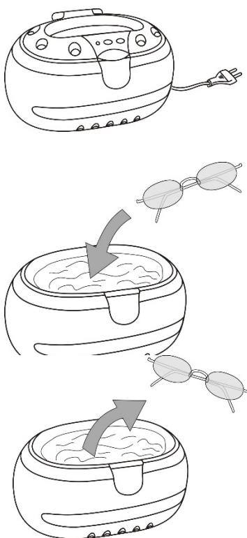
1. Deksel openen en het te reinigen voorwerp in het reinigingsreservoir leggen. Vervolgens met water opvullen. U kunt ook een speciale ultrasone reinigingsvloeistof gebruiken om een beter resultaat te krijgen. Het apparaat vullen tot de Max vulstand markering.
