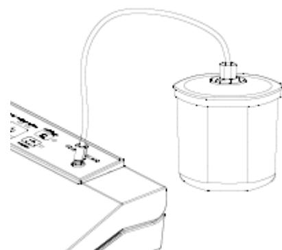
Compruebe la indicación de estado LED para observar la intensidad del vacío; debe estar seleccionado el ajuste "normal". Cierre la tapa. Gire la palanca a derechas hasta que quede bloqueada. Pulse "recipiente de vacío" (Behälter). Presione firmemente la tapa al principio del proceso de vacío para evitar que salga aire. El proceso de vacío finaliza automáticamente cuando se alcanza una intensidad de vacío suficiente.
