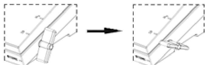
**Fase 3:** Dopo questo processo, girare la leva in senso antiorario finché il coperchio è sboccato (al termine della saldatura).
