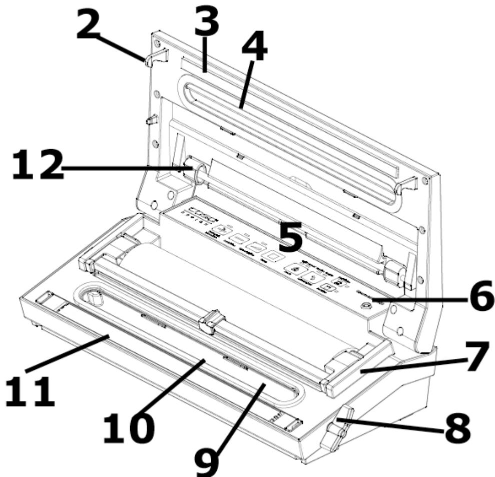
**2 Crochets de verrouillage pour le couvercle**
