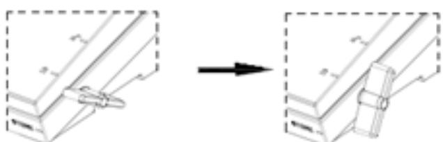
**Etape 3 :** Tournez ensuite le levier dans le sens inverse des aiguilles d'une montre jusqu'à ce que le couvercle soit déverrouillé (une fois le processus de scellement achevé).
