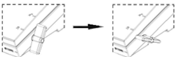
**Etape 2 :** Refermez le couvercle de l'appareil. Tournez le levier dans le sens des aiguilles d'une montre jusqu'à ce que le couvercle soit verrouillé.
