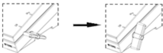
**Fase 3:** Dopo questo processo, girare la leva in senso antiorario finché il coperchio è sboccato (al termine della saldatura).
