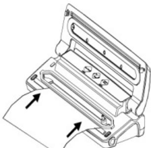
**Шаг 1:** Поднимите крышку и разместите открытую сторону пакета в вакуумной камере.
