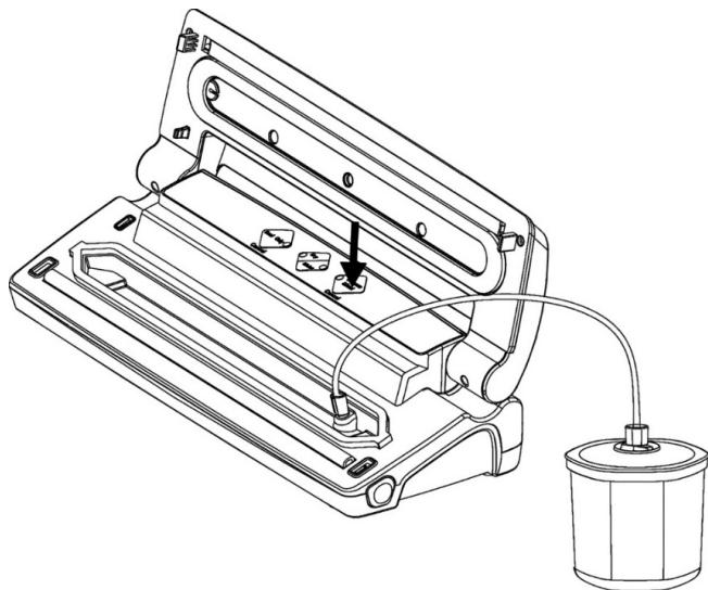
3. Druk op de toets „ Vakuum & Schweißen” (vacumeren/sealen). Druk aan het begin kort op het deksel van de vacuümbak. Het apparaat stopt automatisch wanneer het vacuüm wordt bereikt. Vervolgens kan de vacuümslang en eventueel de adapter worden verwijderd.
