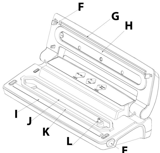
**J Vakuumkammer:** Positionieren Sie die Öffnung des Beutels in der Kammer.
