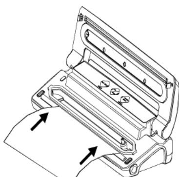
1. Open de klep van de vacumeerfolie opbergbox. Rol de folie uit op de voor u gewenste lengte en snij het met de cutter precies en nauwkeurig op de gewenste lengte af.
