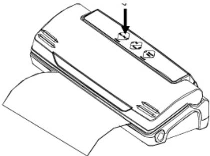
4. Druk op de knop „B“ sealen (Seal), Vervolgens zal het apparaat lucht binnenlaten, de seal verbreken en piepen. Indien controlelampje gaat uit, is de zak versegeld.
