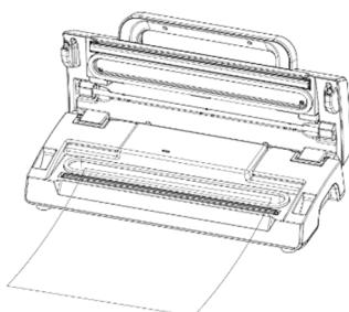
Vérifiez que le bout ouvert du sachet se trouve dans la chambre de dépressurisation pour garantir que l'air ne s'échappe pas. Fermez le couvercle et enfoncez fermement la poignée jusqu'à ce que la première LED de fonction s'allume.
