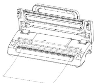
Coloque un extremo de la bolsa sobre la barra de sellado.
