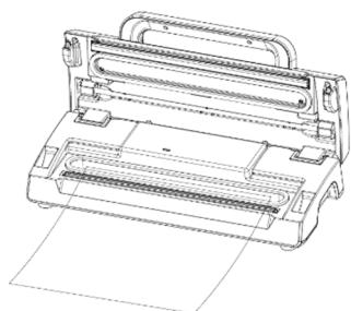
Limpie y alise el extremo abierto de la bolsa y asegúrese de que no hay pliegues ni arrugas en las superficies del extremo abierto.
