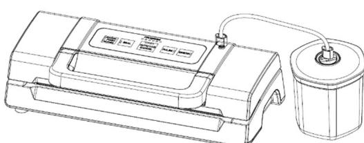
Fissare un'estremità del tubo flessibile per la messa sotto vuoto all'attacco sull'apparecchio e un'estremità all'attacco sul coperchio del contenitore.
