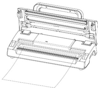
Platzieren Sie das offene Ende des Beutels in der Vakuumkammer. Schließen Sie den Deckel und drücken Sie den Griff fest herab, bis die erste Progress-LED leuchtet und wählen Sie die von Ihnen gewünschte Versiegelungszeit aus.
