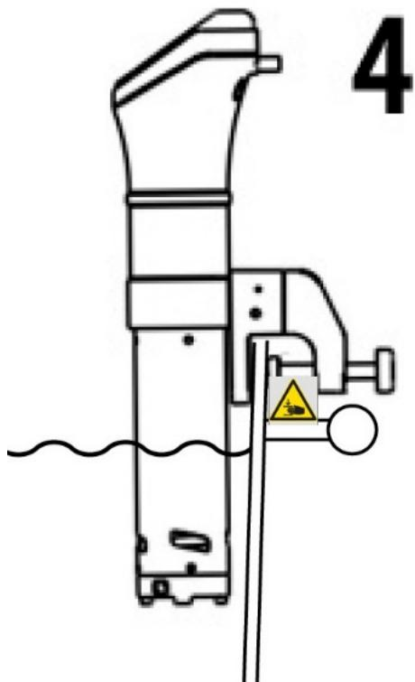
Fissare l'apparecchio, bloccandolo fisso al recipiente di cottura.
