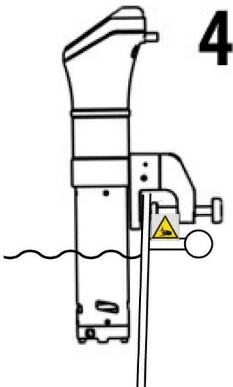
Fixez l'appareil en le bloquant sur le réceptacle.
