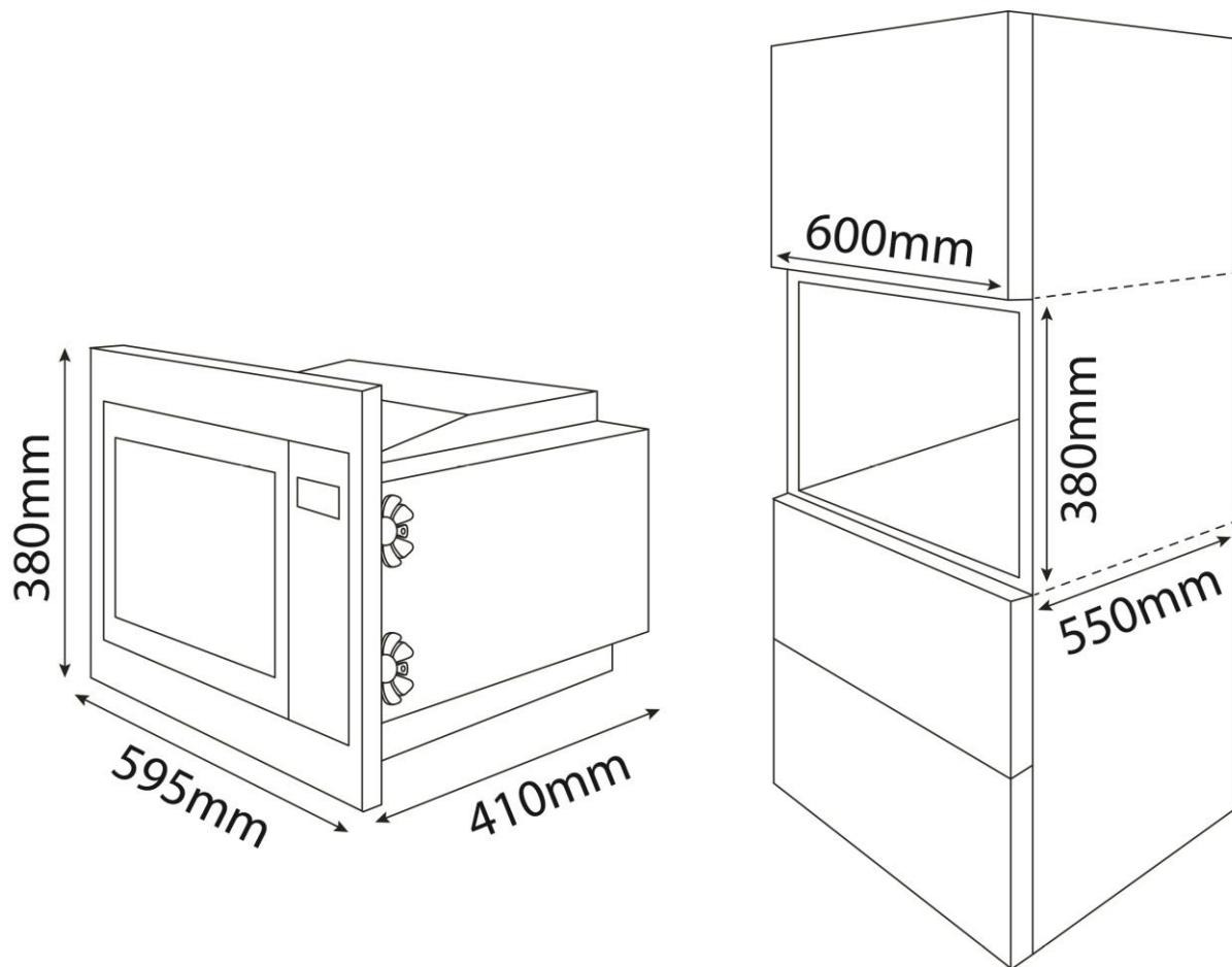
Das Stromkabel nicht einklemmen oder knicken. Das Gerät mittig im Fach einbauen.
