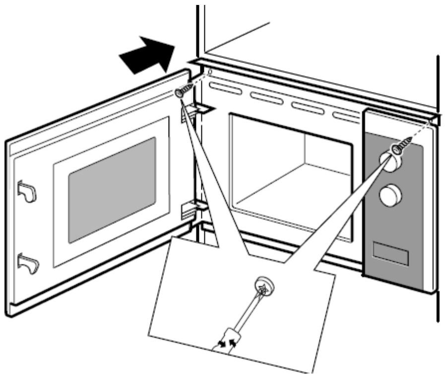
Evite que el cable de alimentación quede atrapado o doblado. Monte el aparato en la parte central del compartimento. Deje un espacio de separación de 30 mm por encima de la parte superior del aparato.
