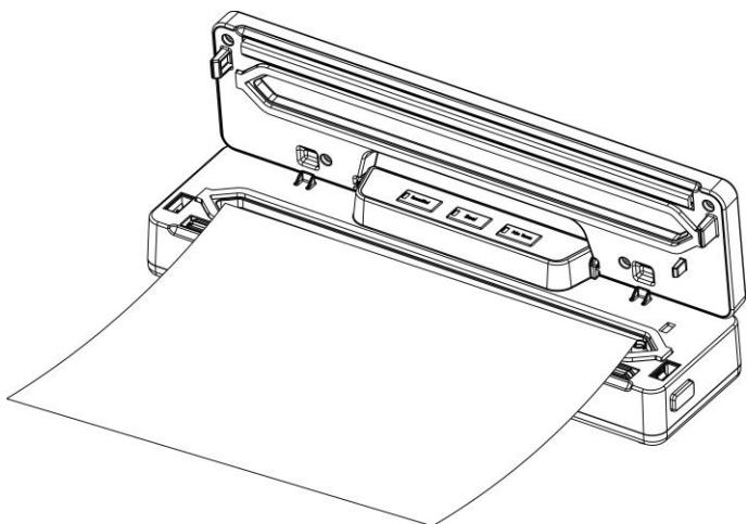
Se è necessario interrompere l'operazione, prima premere il **tasto Messa sotto vuoto e Sigillatura (Vakuum & Schweißen)** e poi i tasti “Sblocco”, per aprire il coperchio.
