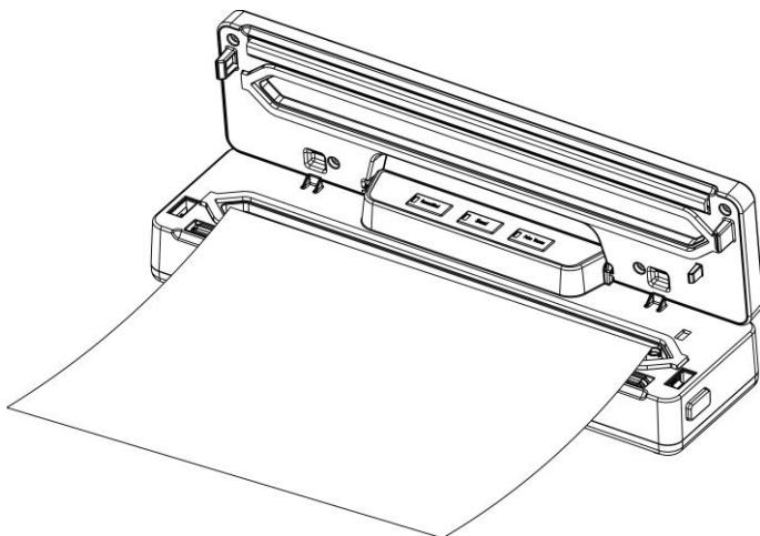
**(Vakuum & Schweißen)** y la bolsa quedará firmemente sellada automáticamente tras el envasado al vacío. El piloto LED correspondiente se iluminará y apagará una vez finalizado el proceso.
