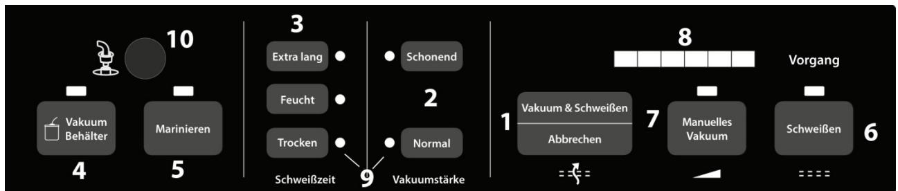
**1 Vacuüm & lassen / afbreken (Vakuum&Schweißen/Abbrechen):** Deze knop heeft twee functies, afhankelijk van de status van het apparaat
