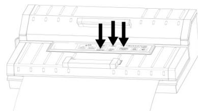
Premere "Sotto vuoto e saldatura" (Vakuum&Schweißen). L'indicatore di avanzamento a LED si accende e automaticamente viene aspirata aria e il sacchetto poi sigillato.
