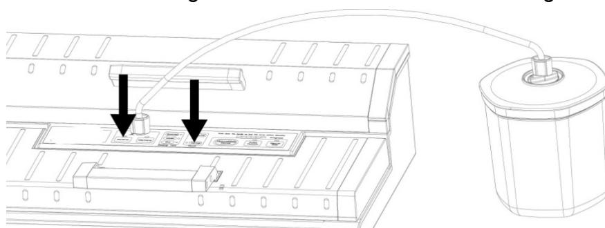
(normal) staan. Sluit het deksel en druk deze stevig naar beneden op het voorste handvat. Druk op „Vacuümbak“ (Vakuumbehälter). Druk bij het begin van het vacumeren het deksel stevig aan, om te voorkomen dat er lucht kan ontsnappen. Het vacumeerproces eindigt automatisch wanneer een voldoende sterk vacuüm is bereikt. Verwijder de vacuümslang van de aansluiting aan het deksel van de bak en aan het apparaat.
