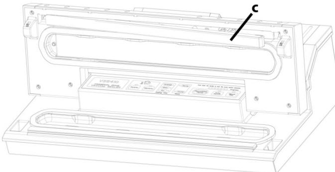
Ziehen Sie den Schweißbalken(c) heraus. Nehmen Sie einen neuen Schweißbalken und pressen Sie diesen in die Mulde im Deckel. Überprüfen Sie den Sitz des Schweißbalkens und setzen Sie die Klammer rechts und links wieder ein.
