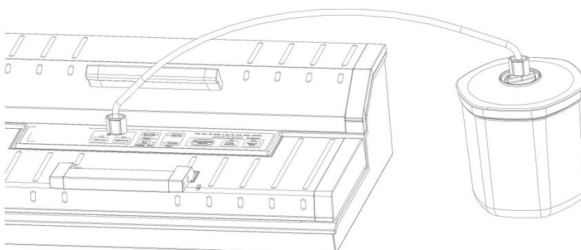
Veeg de vacuümbak en het deksel schoon en droog. Vul het te vacumeren product in de bak. Let erop dat de bak niet te vol is. Sluit het deksel.
