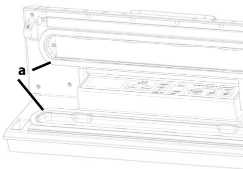
Spegnere l'apparecchio dall'interruttore principale. Lasciare raffreddare completamente l'apparecchio. Aprire il coperchio dell'apparecchio. Rimuovere la guarnizione (a) superiore/inferiore dall'avallamento nel coperchio dell'apparecchio ovvero dall'avallamento intorno alla camera del sotto vuoto. Inserire la nuova guarnizione e premerla dentro fissa con le dita.
