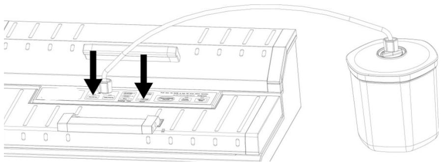
Pulse "recipiente de vacío" (Vakuumbehälter). Presione firmemente la tapa al principio del proceso de vacío para evitar que salga aire. El proceso de vacío finaliza automáticamente cuando se alcanza una intensidad de vacío suficiente.
