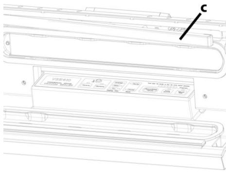
Levante con cuidado la barra selladora (c) utilizando un objeto romo para retirarla. Tome una barra selladora nueva y presione sobre ella para fijarla a la moldura de la tapa. Asegúrese de que la barra selladora quede bien asentada y coloque las abrazaderas derecha e izquierda nuevamente en su lugar.
