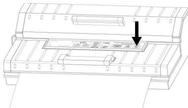
Druk de voorste handgreep weer naar boven, open het deksel en verwijder het zakje. Het zakje kan nu worden gebruikt voor het vacumeren.
