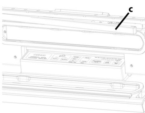
Faites soigneusement levier avec un objet non contondant pour sortir la barre de scellage (c). Retirez la barre de scellage (c). Prenez une barre de scellage neuve et enfoncez-la dans le creux du couvercle. Vérifiez la bonne tenue de la barre de scellage et remettez les crochets de droite et de gauche.
