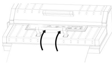
Pulse "Vacío y sellado".(Vakuum&Schweißen) La indicación de progreso LED se iluminará y se aspirará aire automáticamente hasta sellar la bolsa.
