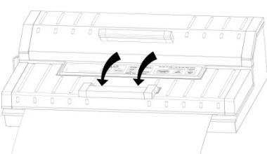
Asegúrese de que ambos lados del extremo abierto de la bolsa se encuentran dentro de la cámara de vacío. Esto garantiza que no se abra el vacío.
