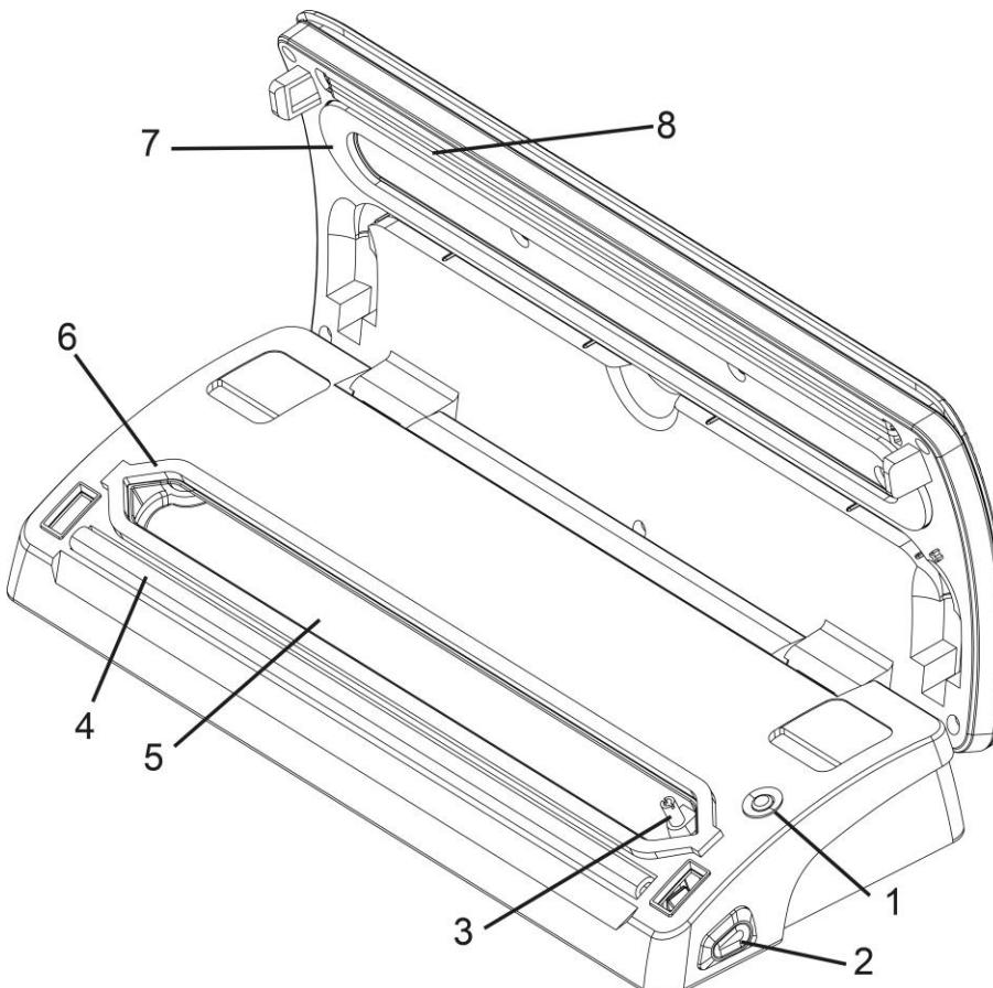
**1 Sicherheits-Schalter:** Wird bei geschlossenem Deckel ausgelöst.
