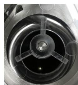
Voor de demontage draait u het roestvrij stalen schort tegen de wijzers van de klok in.
